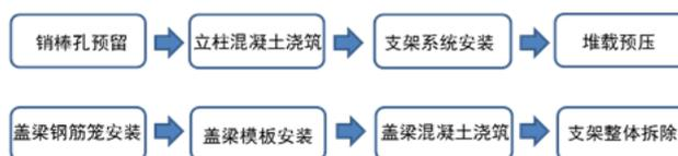
图 2-10 盖梁钢筋模块化附着式支架施工
