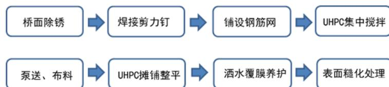
图 2-8 钢-UHPC 组合现浇桥面板施工流程
