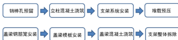
图 2-9 盖梁钢筋模块化附着式支架施工
