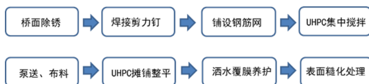
图 2-7 钢-UHPC 组合现浇桥面板施工流程
